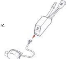
4 Alarmın kurulumu için, NF/NO (normal açık/normal kapalı) bağlantılar mevcut, kesinti gücü tavsiye = 2A = 5A (Maks.) Alarmı, elektrik kurulum şemasına göre bağlayınız.
