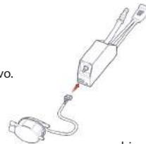
4 Per il collegamento dell'allarme, disponete di contatti NA/NC (normalmente aperto/normalmente chiuso), potere di interruzione consigliato = 2A = (5A Max.). Collegare l'allarme in funzione dello schema elettrico dell'impianto.
