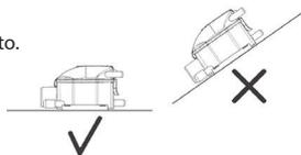
4 Installare il sensore in orizzontale con l'ausilio del supporto fornito.
