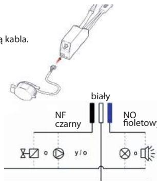
4 Do podłączenia alarmu służą styki NO/NF (normalnie otwarty/normalnie zamknięty), a moc rozłączania zalecana = 2A (5A Maks.). Podłączyć alarm na podstawie schematu elektrycznego instalacji.
