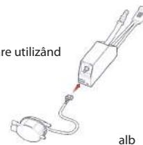
4 Pentru conectarea alarmei dispuneți de contacte normal închis / normal deschis (NÍ/ND) cu o valoare recomandată maximă a curentului de comutație de 2A (5A Max). Conectați alarma așa cum este indicat în schema electrică.
