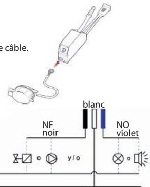
4 Pour le raccordement de l'alarme, vous disposez de contacts NO/NF (normalement ouvert/normalement fermé).
