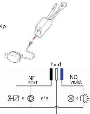
4 De to kontakter NO/NC (normalt åben/normalt lukket), brydeeffekt anbefalet = 2A = 5A (Max.), kan bruges til tilslutning af alarm. Tilslut alarmen i forhold til installationens elektriske diagram.
