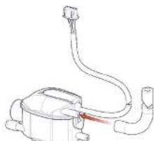
4 Conectați tubul scurt, transparent, la orificiul din capac și orientați-l în sus
